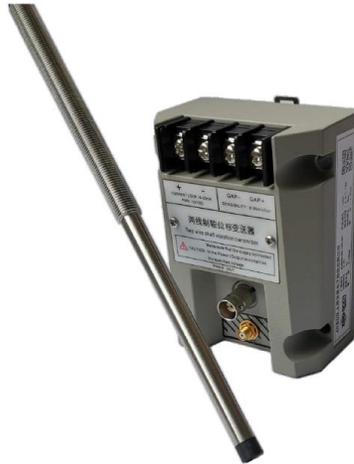
TP6000 系列两线制轴位移变送器，主要是针对离心压缩机、小型水泵、汽轮机、风机或电机设备的经济型轴位移解决方案。它可将轴位移信号，按照测量量程等比例转换成 4-20mA 信号提供给 DCS/PLC，以便机组的监视、报警和联锁逻辑控制。
